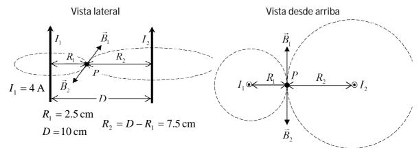
Campo magnético creado por la corriente  $I_1$ : Corriente transportada por  $I_2$ , siendo  $B_2 = B_1$
