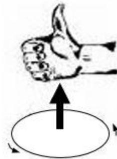
Explicación alternativa: la causa de la aparición de la fem inducida en este caso es el debilitamiento del campo magnético, lo que reduce el flujo. Así que el sistema responde con una corriente inducida que tiende a reforzar el campo magnético: tal corriente ha de tener sentido antihorario para generar un campo magnético adecuado.
