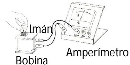
La opción a) es incorrecta, pues se observa experimentalmente que la aguja del amperímetro se mueve mientras que se está introduciendo el imán en el interior de la bobina, ya que ese cambio de posición del imán produce una variación de flujo magnético con el tiempo, y esto genera una corriente inducida.
